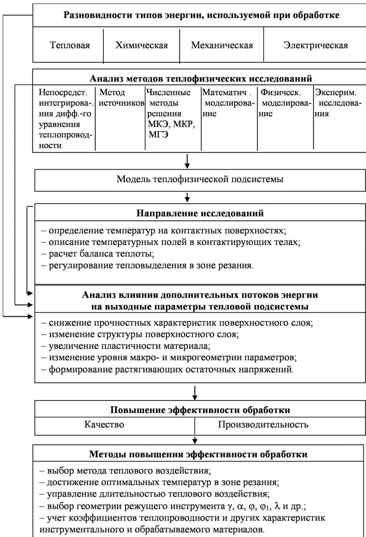
Рис. 1. Применение системного подхода к анализу и выбору теплофизической модели
